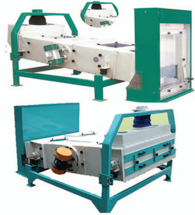
ماكينة غربة الشعير جميع انواع البقوليات و الاعشاب تشمل دائرة هواء لتنظيف المنتج قدرات كهربائية مختلفة - قدرات انتاجية مختلفة
