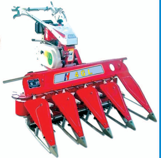
حصادة قمح متعددة محرك ديزل ١٠ حصان عرض سكينه القص متر و ٢٠ سم ٢ سرعة امامية و ٢ سرعة خلفية
